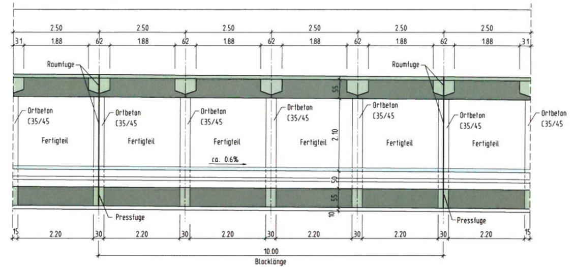
Regelquerschnitt Fertigteilrahmen M.1:50
