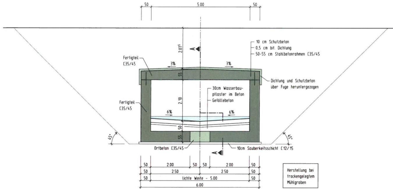
Längsschnitt A-A Fertigteilrahmen M.1:50
